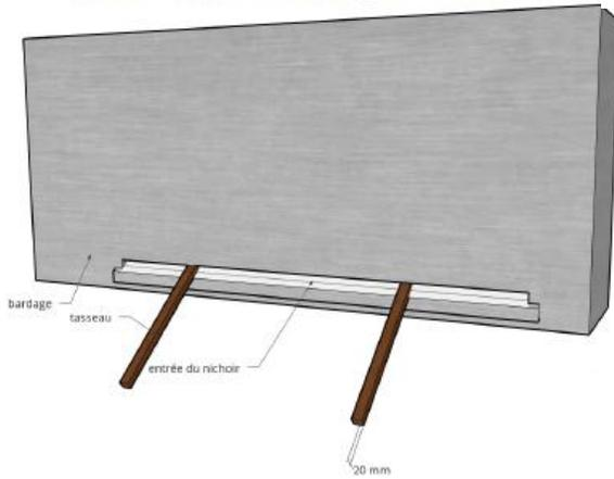
Vue après la pose de l'isolant et du bardage et le retrait des tasseaux
